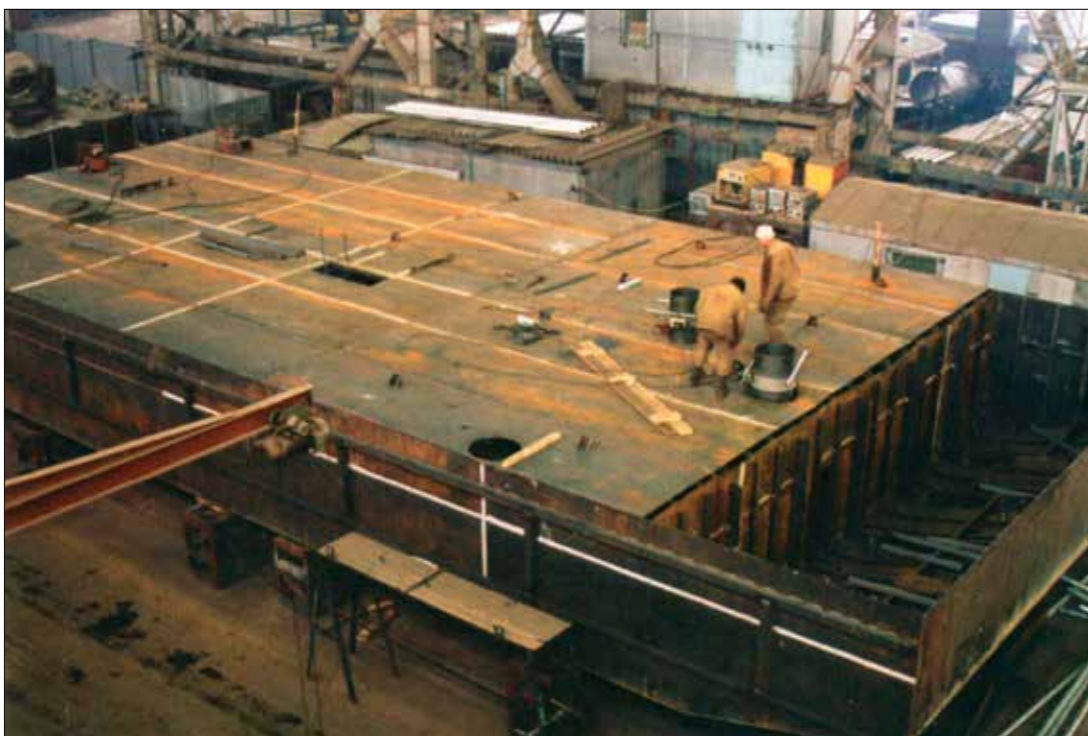
Изготовление основания суперблока
