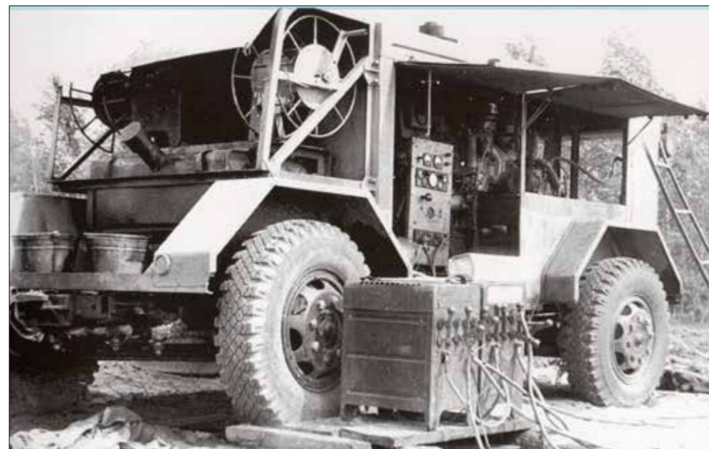
Полевая автосварочная установка ПАУ-602. Разработана на базе сварочного агрегата АСДП-500 Г, который более 30 лет обеспечивал сварочные работы на всех строящихся магистральных трубопроводах. Его роль и значение можно образно сравнить с легендарным танком Т-34 времен Великой Отечественной войны.
