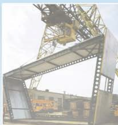
Волоколамск. Завод строительных конструкций. Новая технологическая линия сварки корпусов вагон-домов
